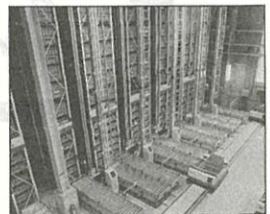
小物保管・管理の決定版AS/RS高速小型立体自動倉庫(ファインストッカー)
