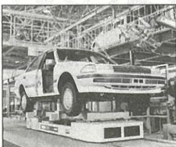
自在な走行モードでフレキシブルな搬送を実現するモノレールシステム(ラムラン)
